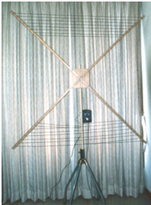
写真1 ループアンテナ全景
